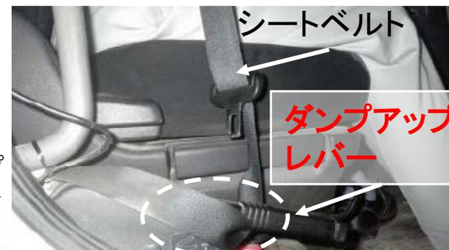
シートベルトがダンプアップレバーに絡んだ状態。シート着脱時は、この状態にならないように注意！
